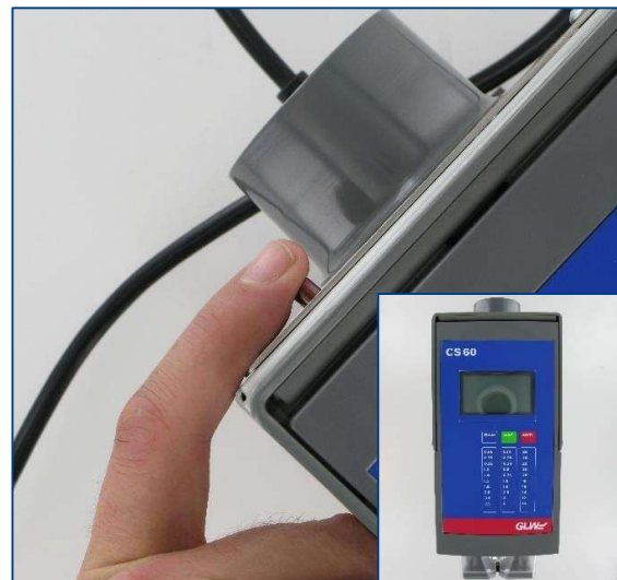
Reset-Taste drücken. Neue Einstellung testen und gegebenenfalls nachjustieren. Press reset button. Test the new adjustment and make new adjustments if necessary.
