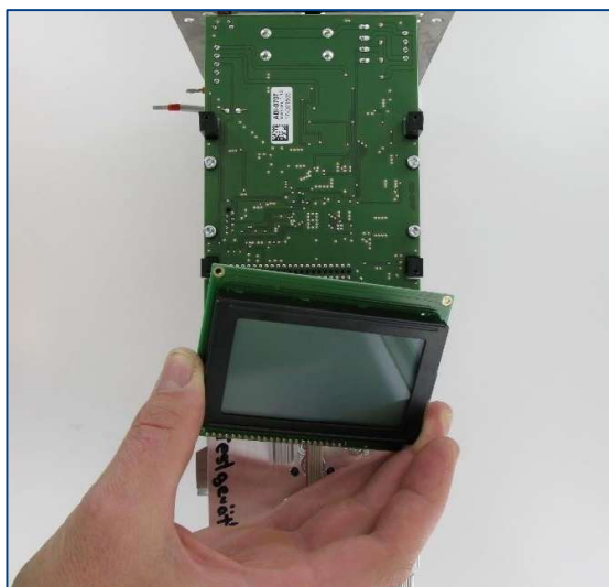
Displayplatine vorsichtig diskonnektieren
