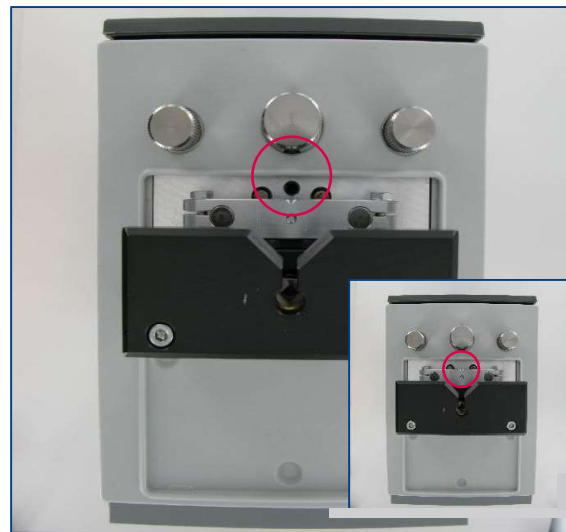
Siegel entfernen. Gewindestift zum Einstellen des Endanschlags wird sichtbar
